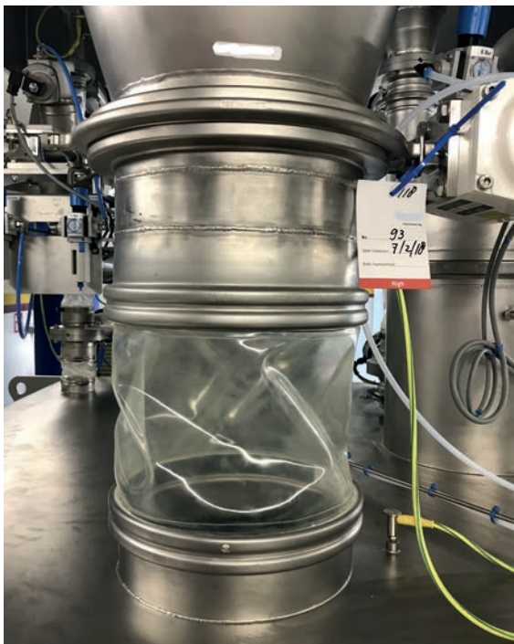
Afb. 2 Een polyurethaan manchet met BFM snaphing is stofdicht en eenvoudig te vervangen
